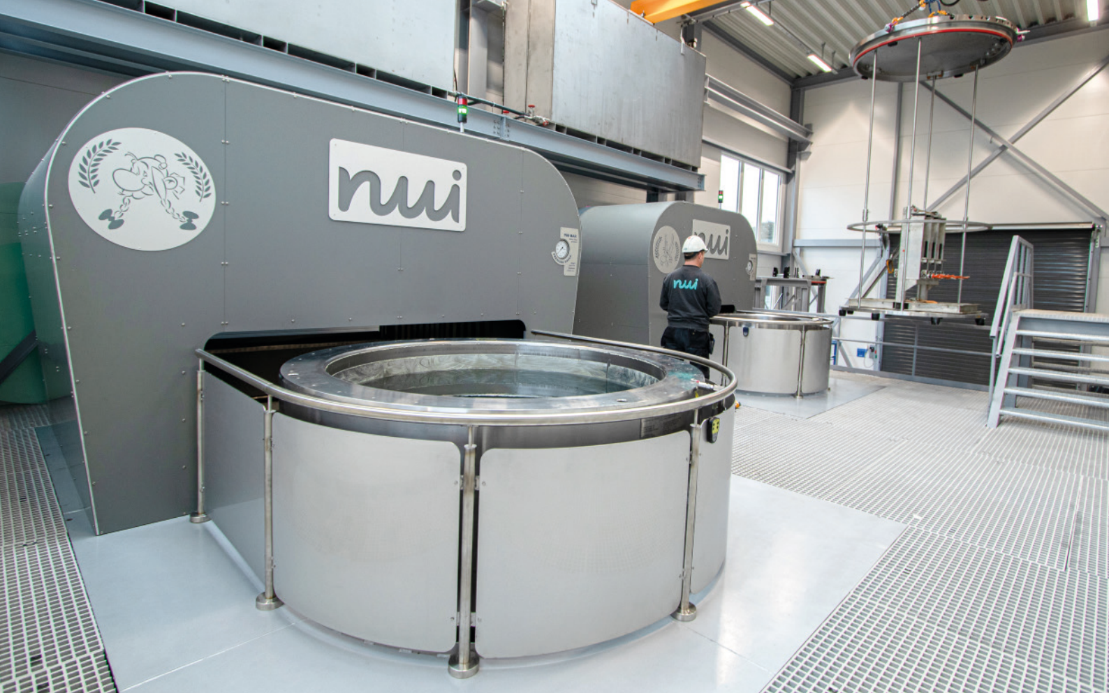
NUI sine trykktanker Asterix og Obelix. De muliggjør hyperbar testing og kollapsesting av undervannskomponenter ved trykk tilsvarende opptil flere tusen meters dyp.
