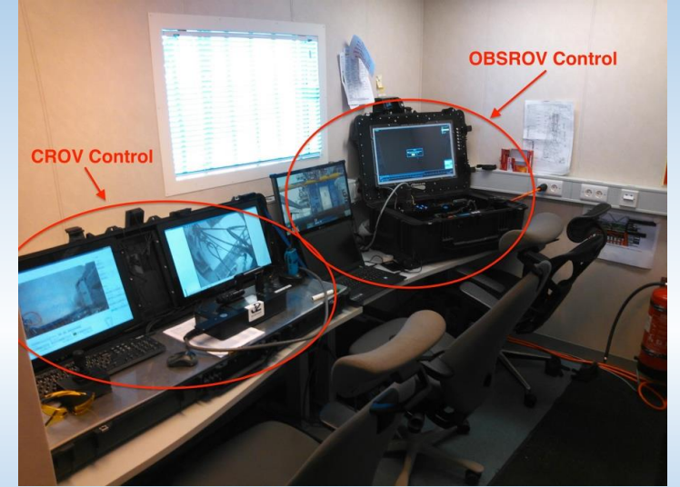
CROV & OBSROV kontrollstasjoner
