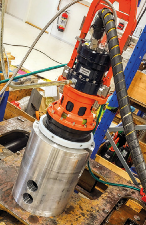
Kvalifisering av Class 7 girboks i dynamisk testjigg.
