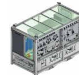
Pumpemoduler er montert på skid for å forenkle tilkomst og vedlikehold.
