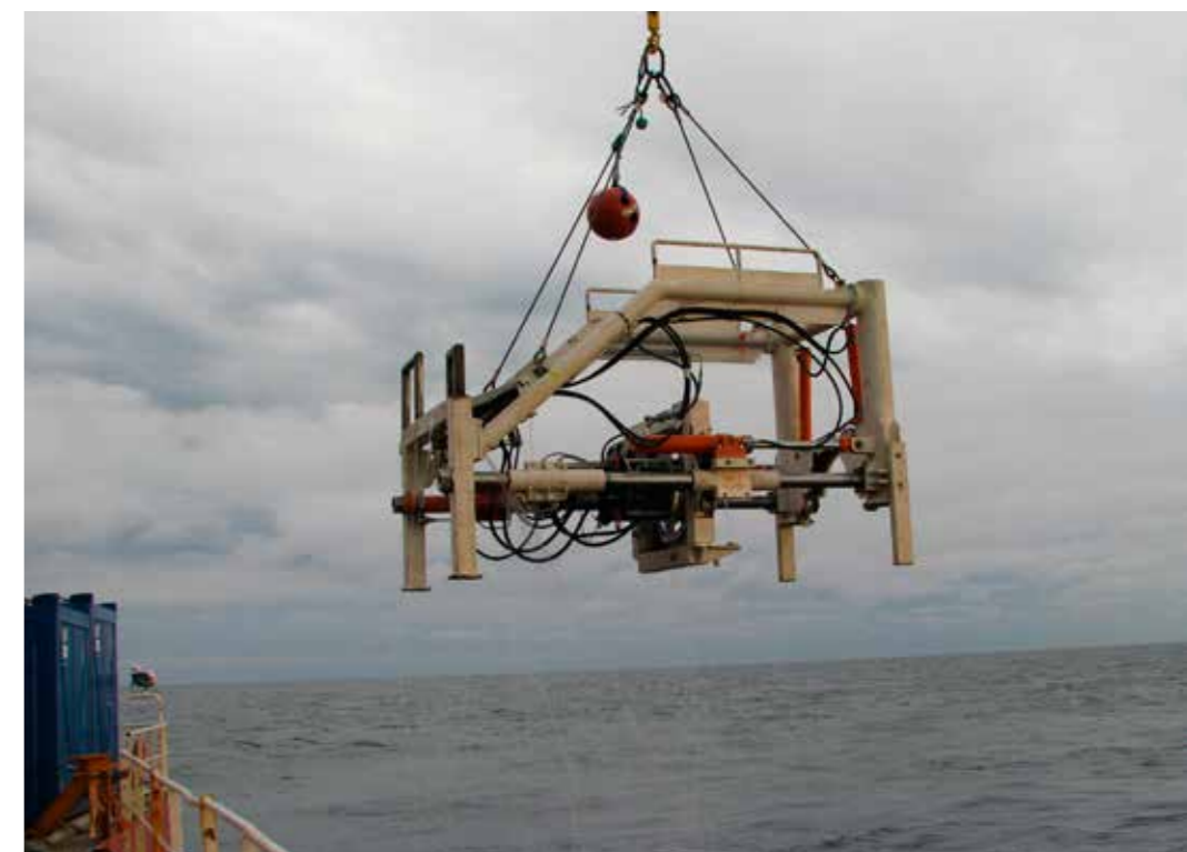
Drilling tool på vei subsea fra Lewek Connector for å gjøre «bore operasjon».
