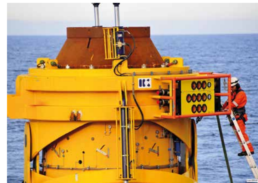
Envirex leverte kontrollsystemet til IK Stavangers Pile / Sleeve Tool som skulle benyttes for å jekke opp, og stive av en produksjonsplattform i Nordsjøen.
