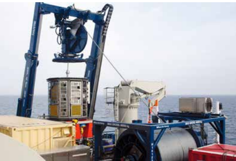
Om bord på R/V Dorado Discovery Odyssey er den elektriske MERMAC-vinsjen med aktiv hevekompenisering i full gang med å betjene avansert boreutstyr på havbunnen på jakt etter mineraler.
