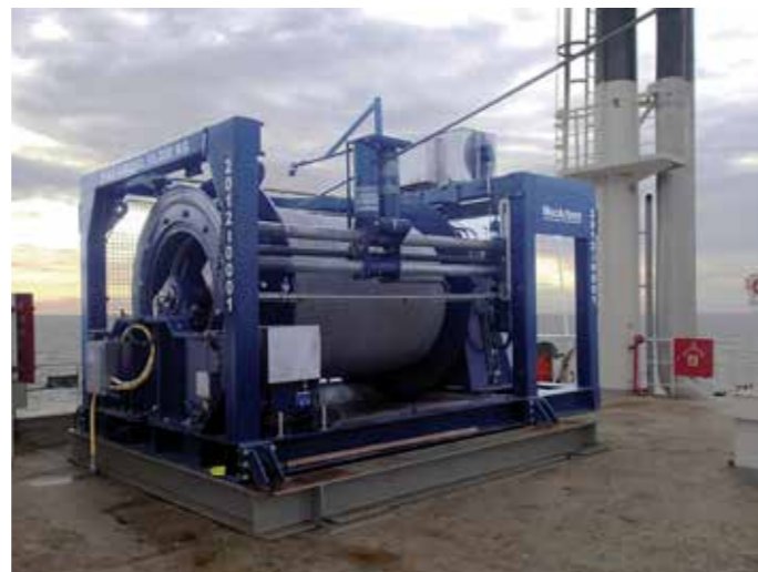
Et SeaBotix Containerized Delivery System (CDS) – et containerbasert leveringssystem – bestående av ROV, TMS, LARS, kontrollrom og en teknisk skreddersydd elektrisk MERMAC AHC-vinsj.
