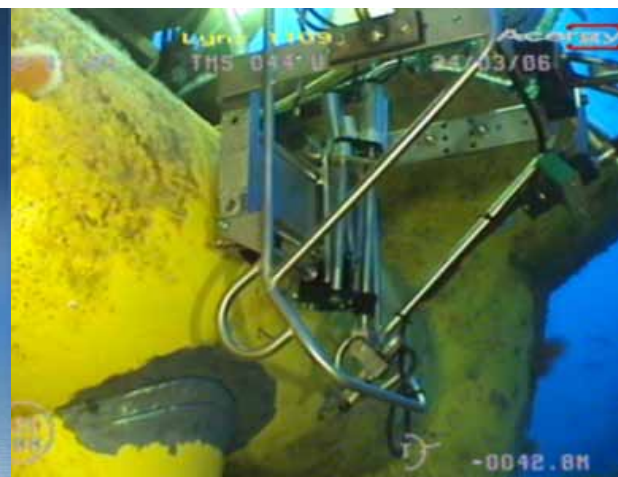
F-Bend. For erosjons- og korrosjonskontroll av rørvegg i bend.
