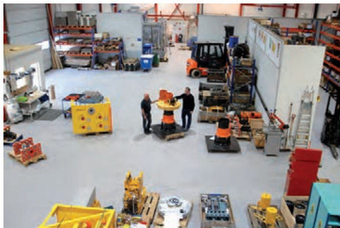
I montasjehallen bygges prototypene som Depro har designet og utviklet. Salgssjef Gaute Kyllingstad og daglig leder Kåre Stokkeland står ved siden av en subsea torque-tool, som er bestilt av GE og skal installeres på Gorgon-feltet på vestkysten av Australia. Prototypen veier tre tonn og er designet for å trekke bolter av anselige dimensjoner.
