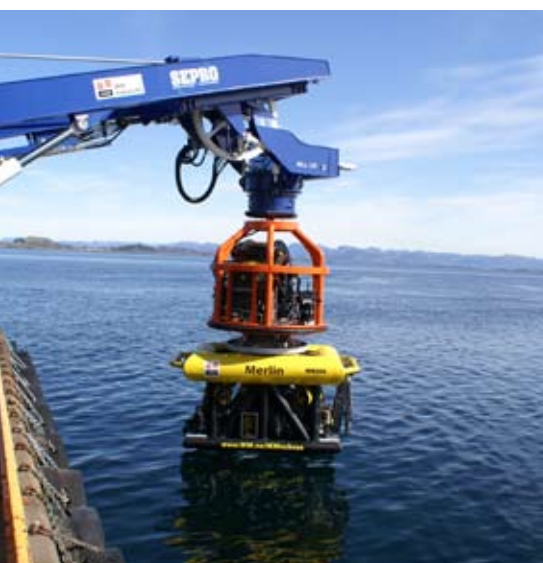
Figur 2: Oversight dipping HPL type LARS under systemtesting ved kai. IKM Subsea ROV, med Malm Orstad TMS, vises frem for kunder i strålende vårsol.
