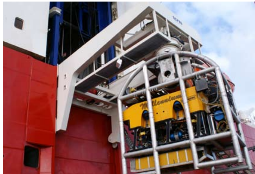
Figur 7: Sepro Overhead Rail System™ (ORS™), som i tillegg til å føre ROV/TMS horisontalt ut og inn av hangaren går vertikalt langs skinnegang på utsiden av skutesida. Denne funksjonen er viktig når det er stor høydeforskjell mellom hangar og vannflate. Systemene på dette fartøyet opereres av Oceaneering med Oceaneering Millennium ROV & Cage.
