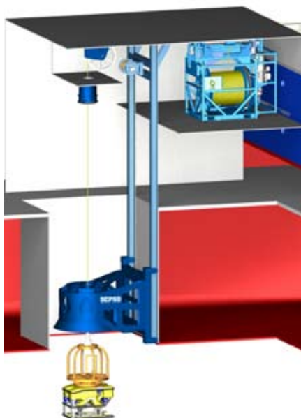
Figur 3: Prinsippskisse av et Moonpool Launch & Recovery System. Systemet er vist med en Malm Orstad TMS og Kystdesign ROV. Umbilicalvinsjen er en viktig del av systemet – en Cetix AHC Waverunner med transversal spoleapparat ses øverst i bildet. Den hydraulisk opererte luken over moonpool er blant mange detaljer som ikke er vist på tegningen.
