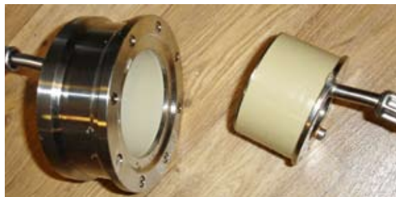
Figur 1 Overføring av strøm og kommunikasjon foregår gjennom det grå PEEK materialet
