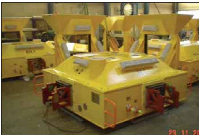
SDU ferdigstilt med MQC plater, connectorer og Guide funnels
