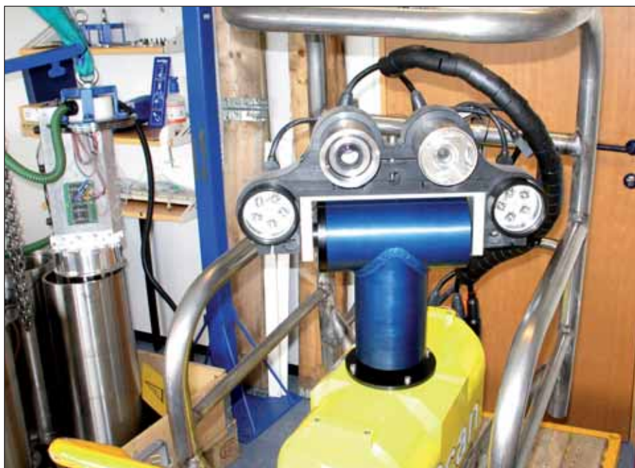
Bildet viser et digitalt kamera system utstyrt med lyskilder bestående av lysemitterende dioder. Hele kamerasystemet er fjernstyrt for bevegelse i alle retninger (pan/tilt)
