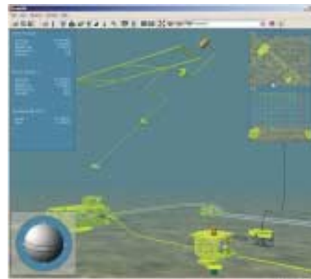
"VIZeye" hovedskjerm under installasjonsfasen, her kan man enkelt "vandre inn i bildet" og se på detaljer fra valgte posisjoner ("snu seg etter behov").
