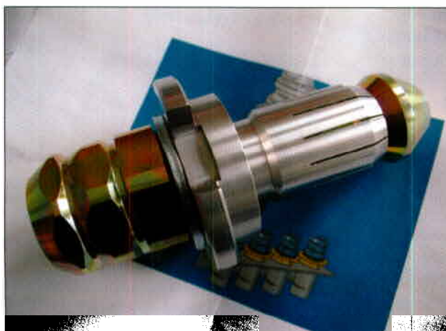
Bildene viser anvendelser i forbindelse med festing av plater på en undervannsstruktur. 9 bolter er nå installert på et vann dyp på 350 meter. Boring av hull inngikk som en del av prosjektet.
