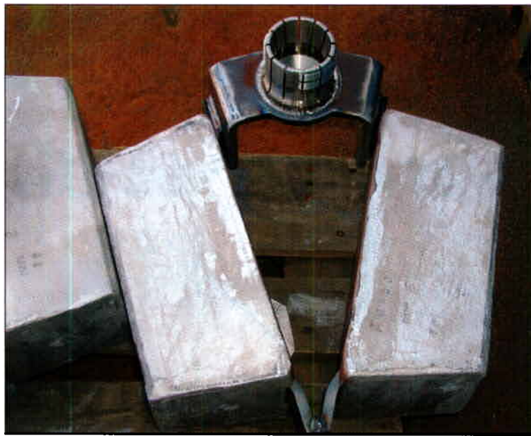
Bildet viser anoder montert på ekspansjonsbolt med diameter på 87 mm.
