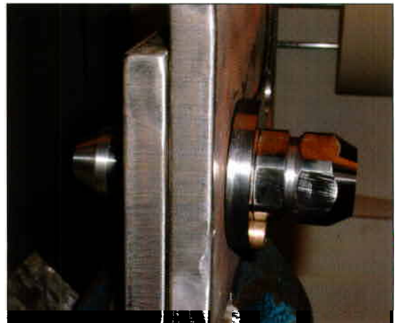
Bildene viser anvendelser i forbindelse med festing av plater på en undervannsstruktur. 9 bolter er nå installert på et vann dyp på 350 meter. Boring av hull inngikk som en del av prosjektet.
