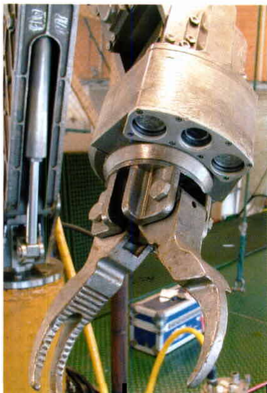
Foto av prototype-kamera på veksteden hos Imenco Technology AS. Kamerahuset er i 316 rustfritt og aluminium, mens produksjonsmodell vil bli laget i S165M høystyrke rustfritt stål. Prototypen er fotografert etter fire måneders bruk offshore.
