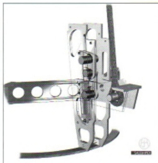
Låsemekanisme med detaljer i titan. Bildet viser en delvis gjennomskåret løftefot, med hydraulikkylinder og mekanisk sammenstilling. (Grafikk ved Brødrene Johnsen Saleimpex A/S)
