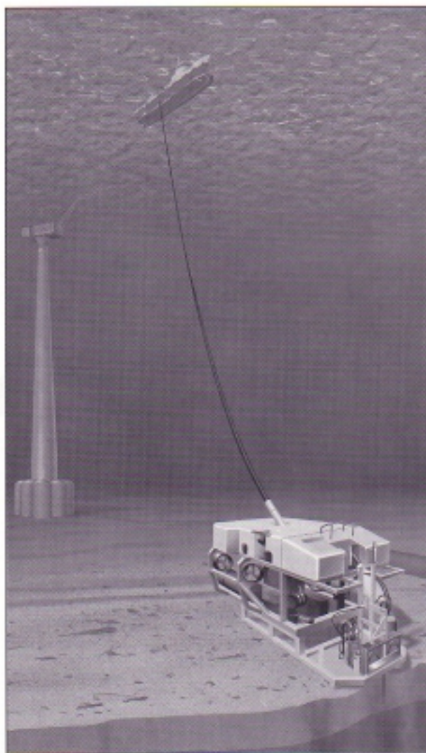
CPT utført med ROV
