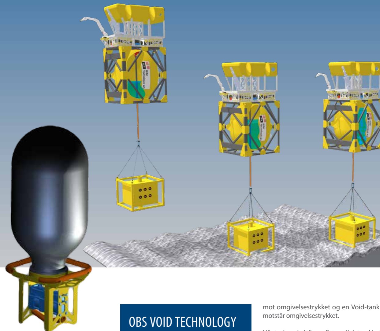
Illustrasjonen viser en utgave som er tenkt brukt som et enkelt hjelpemiddel for ROV for å flytte komponenter. Tanken kan skiftes ut på fartøy til størrelser mellom 50 og 200 kilo oppdrift. Kobles til ROV med Hot Stab.
