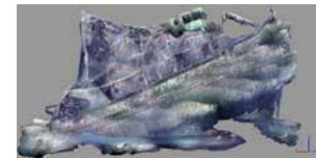
Fotogrammetri modell av stålvraket. På modellen kan informasjon fra de ca 4400 bildene legges til på som tekstur. Illustrasjon Stein M. Nornes.
