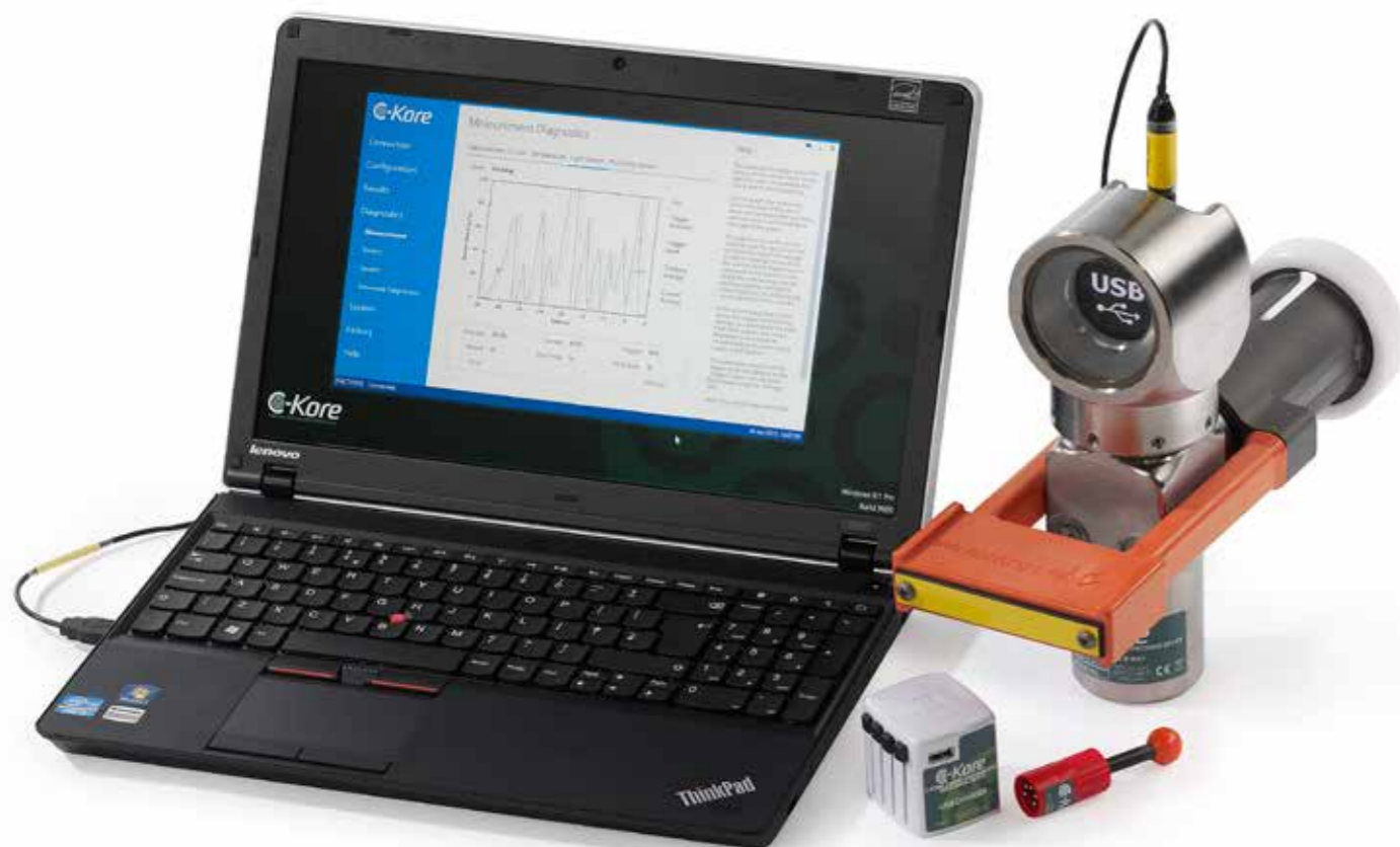
C-Kore stab er en undervanns testenhet som kan benyttes for å måle tilstanden på elektriske deler av et undervannssystem. Foto: C-Kore Systems Ltd
