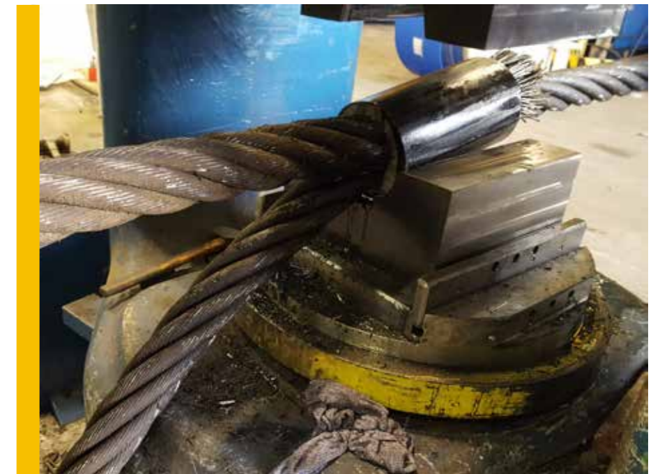
Låsing av karbonstål-lås på 90mm wire ved HVG sine produksjonsfasiliteter i Stavanger.
