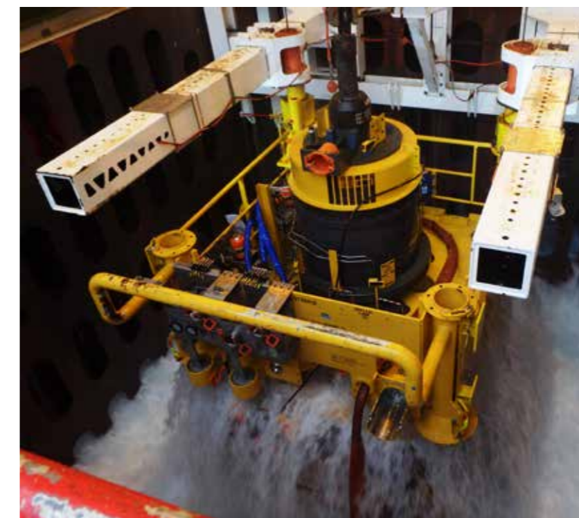
Ventiltre på veg opp til dekk.
