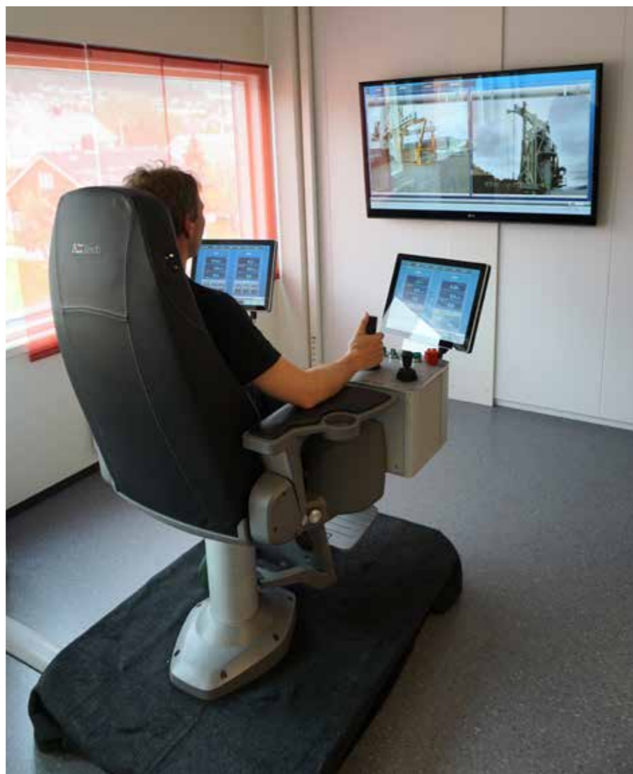
Kontrollrom for testing av fjernstyrte løfteoperasjoner
