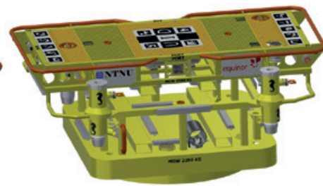
Komplett teststasjon/Subsea Docking Station
