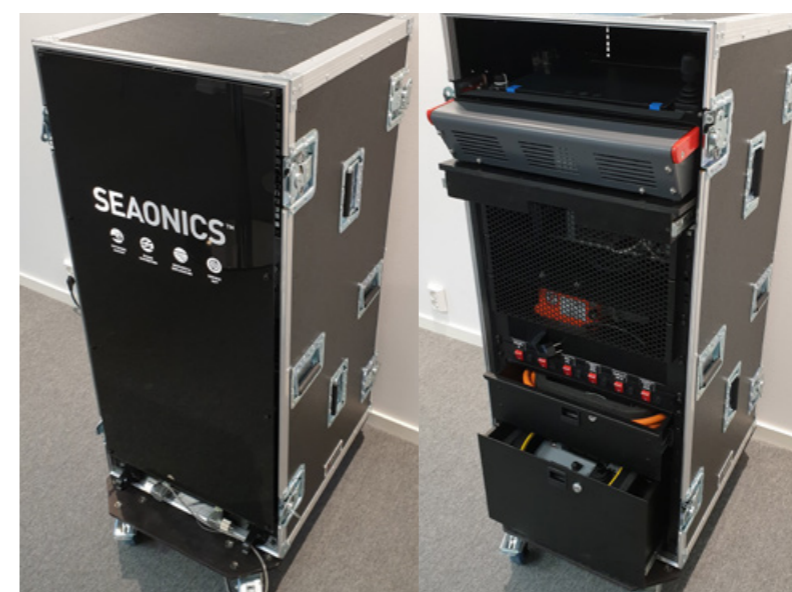
Simulatorene som leveres til riggen består kun av en transportkasse på hjul med simulator, maskinvare for kjøring av styresystem, kontrollpanel for vinsjen, radiostyring og en instruktørstasjon i form av et nettbrett.
