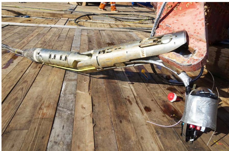
Gammel thruster med koblingsverktøy på dekk etter løft fra Heidrun B til IMR-fartøy.
