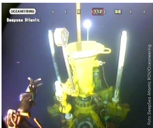
Boring av Peon test brønn med RMR system.
