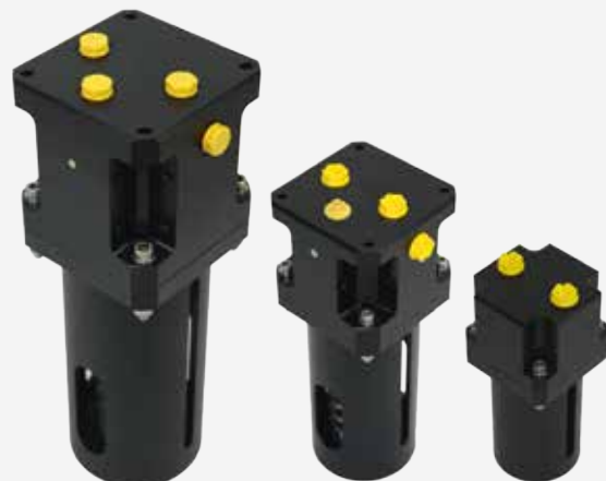
Robuste og pålitelige KD Pan / Pan & Tilt enheter. Moment: • >100Nm max vrilmoment • 35Nm@30 deg/s rotasjonshastighet
