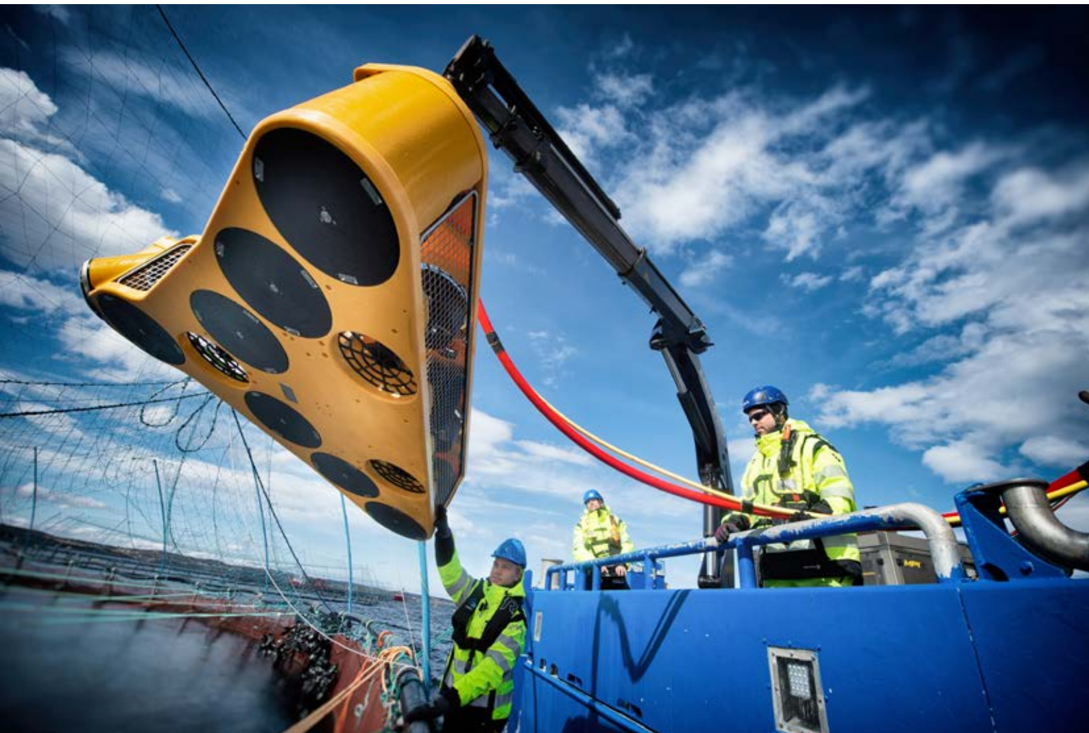
Stealth Cleaner er den eneste kommersielle farkosten i sitt slag med 6 DOF (Degrees of Freedom).
