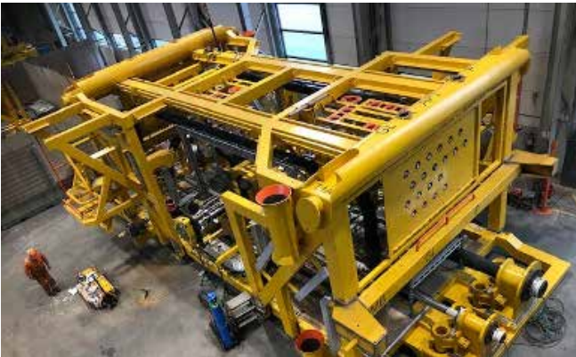
Bunnramme og Manifold fabrikkert av Randaberg Industries AS
