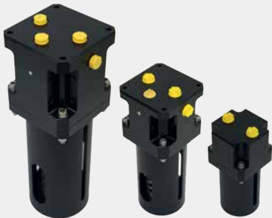
Robuste og pålitelige KD Pan / Pan & Tilt enheter. Moment: • >100Nm max vrilmoment • 35Nm@30 deg/s rotasjonshastighet
