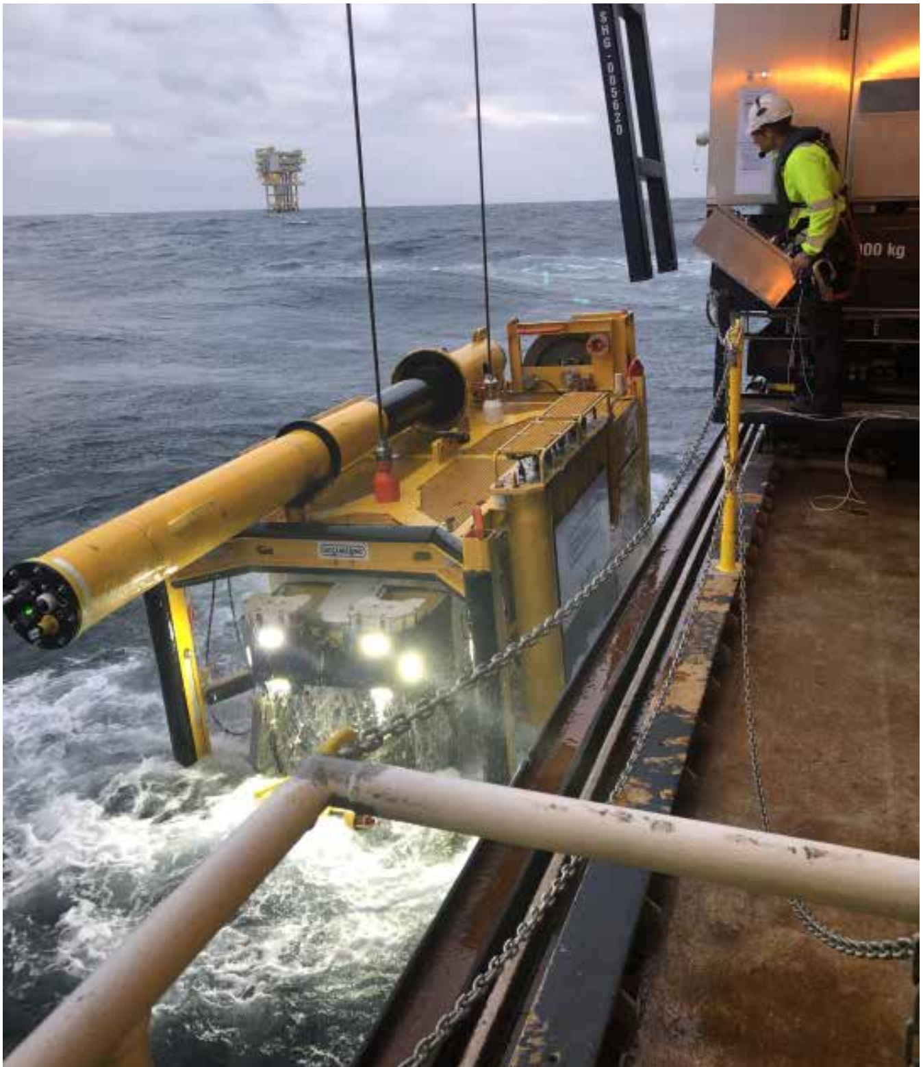
E-ROVen settes ut fra båten, kan etterlates der og jobbe på stedet. Den er batteridrevet med et 500 kwh batteri.
