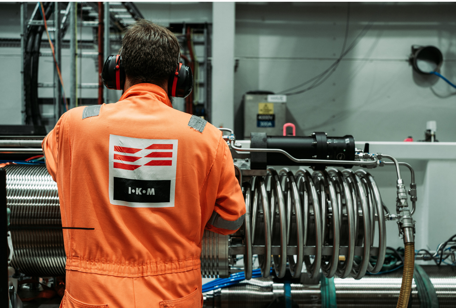
Testansvarleg gjennomfører siste inspeksjon av ein pumpemotor som har gjennomgått ein fulllasttest.
