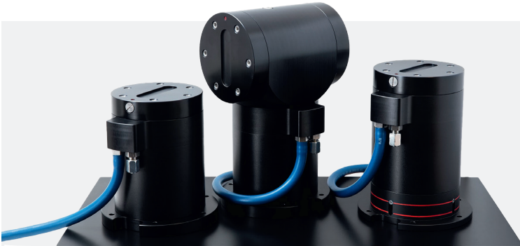
Robuste og pålitelige KD Pan / Pan & Tilt enheter. Moment: • >100Nm max vrimoment • 35Nm@30 deg/s rotasjonshastighet
